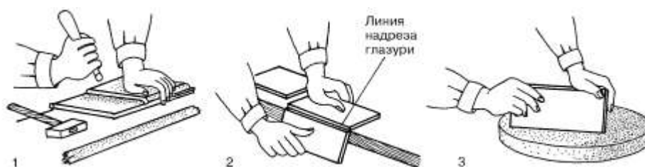
Рис. 25. Подготовка плиток: 1 – резка; 2 – раскалывание (разламывание); 3 – приточка кромок
