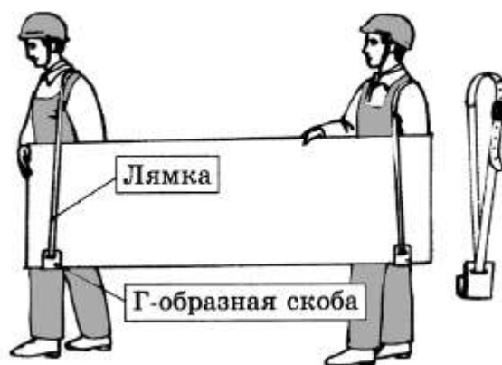
Рис. 6. Переноска листов гипсокартона на лямках
