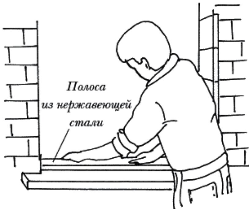
*Рис. 39. Установка полосы из нержавеющей стали*
