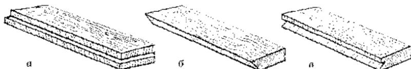
Рис. 3. Виды штучного паркета: а — «специал», б — со скошенными кромками, в — «с фальцем»
