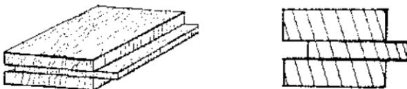
Рис. 2. Планка штучного паркета с пазом и гребнем
