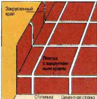
Плитки с закругленным краем укладываются в виде пристенного бордюра или по краям отделанной плиткой лестницы.
