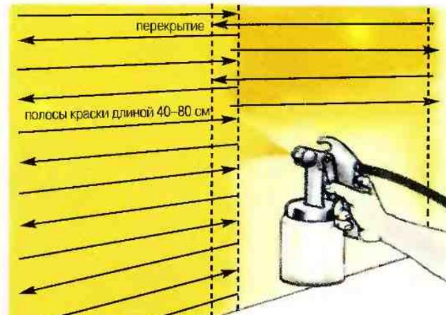
Обширные поверхности окрашивают параллельными полосами; по краям они должны взаимно перекрываться.
