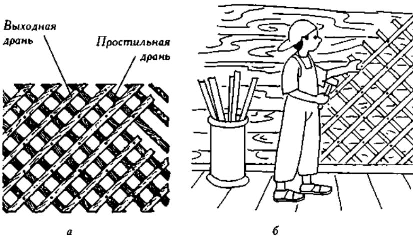
Рис. 3. Подготовка деревянных поверхностей:
