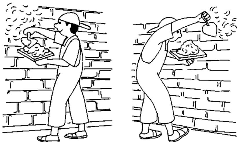
Рис. 8. Нанесение раствора на стены
