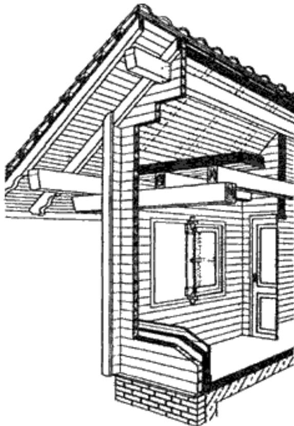
*Рис. 62. Отдельно стоящая баня (аксонометрическая проекция с разрезом).*
