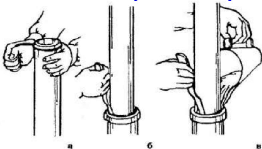
**Рис. 5. Приемы заделки стыков чугунных канализационных труб:** а — намотка прядей; б — осадка прядей; в — заделка асбоцементным раствором
