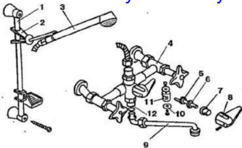
**Рис. 17. Смеситель с золотниковым переключателем, имеющим резиновые кольца и штангу:** 1 — штанга; 2 — держатель; 3 — душевая сетка; 4 — корпус; 5 — кривошип; 6 — нитяное уплотнение; 7 — специальный винт; 8 — рукоятка; 9 — излив; 10 — прокладка золотника; 11 — золотник; 12 — переходник
