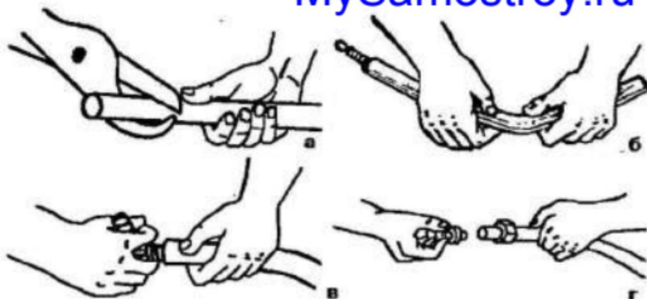
**Рис. 8. Порядок монтажа металлополимерных труб**
