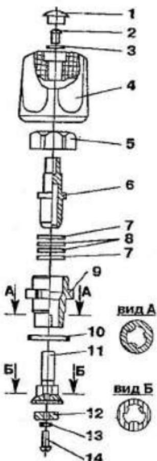
**Рис. 27. Вентильная головка с возвратно-поступательным движением трехпазового шпинделя:** 1 — указатель; 2 — винт; 3 — шайба; 4 — маховик; 5 — накидная гайка; 6 — шток; 7 — пластмассовая шайба; 8 — сальник резиновый; 9 — корпус; 10 — прокладка корпуса; 11 — шпиндель; 12 — прокладка клапана; 13 — шайба клапана; 14 — винт клапана
