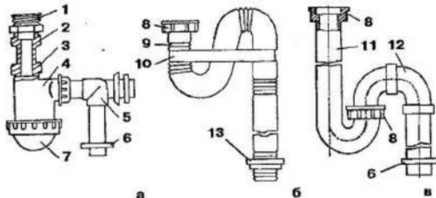
**Рис. 38. Пластмассовые сифоны:** а — для моек типа СБПВсЛМ; б — гофрированный для моек и умывальников; в — двухоборотный с выпуском для моек; 1 — латунный выпуск; 2 — пластмассовый переходной патрубок; 3 — пластмассовая накидная гайка; 4 — стакан; 5 — колено; 6 — резиновое кольцо; 7 — отстойник; 8 — пластмассовая накидная гайка; 9 — гофрированная труба; 10 — пластмассовая стяжка; 11 — полукорпус верхний; 12 — полукорпус нижний; 13 — пластмассовое кольцо
