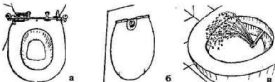
**Рис. 47. Крышки-биде:** а — подсоединеная к унитазу; б — отдельно от унитаза; в — модель фирмы «Geberit» с выезжающей трубочкой
