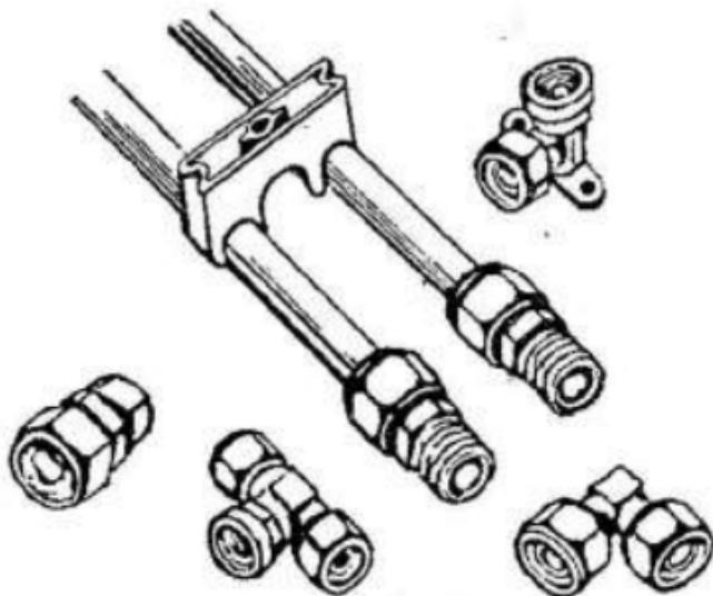
Рис. 7. Соединение с резрезным кольцом
