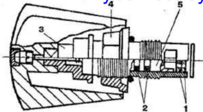
**Рис. 22. Головка с керамическим затвором в сборе:** 1 — притертые керамические диски; 2 — уплотнительное кольцо; 3 — механизм поворота; 4 — регулирующая гайка; 5 — Поворотный цилиндр из самосмазывающейся пласти массы
