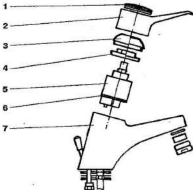
**Рис. 13. Устройство шарнирного смесителя с аэратором и встроенным фильтром:** 1 — фиксирующий элемент; 2 — поворотная рукоятка (джойстик); 3 — крышка корпуса; 4 — круговая гайка; 5 — сменный картридж механической очистки; 6 — прокладка; 7 — корпус
