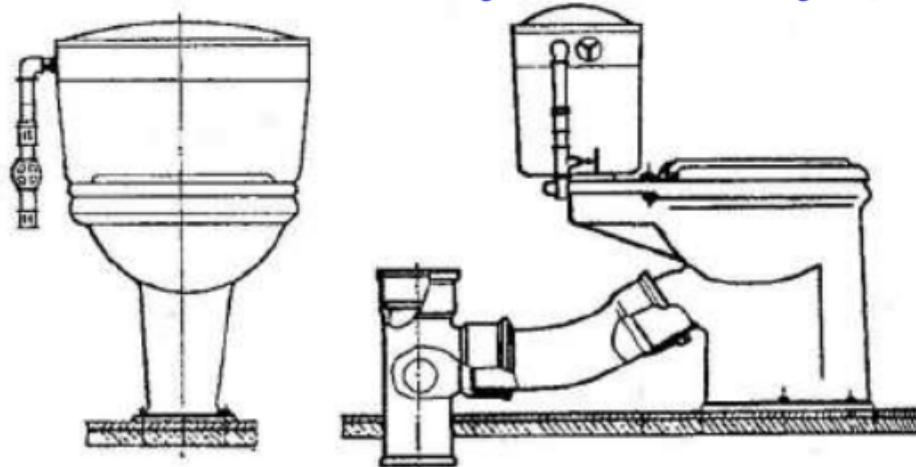
Рис. 41. Установка тарельчатого унитаза с низкорасположенным смывным бачком
