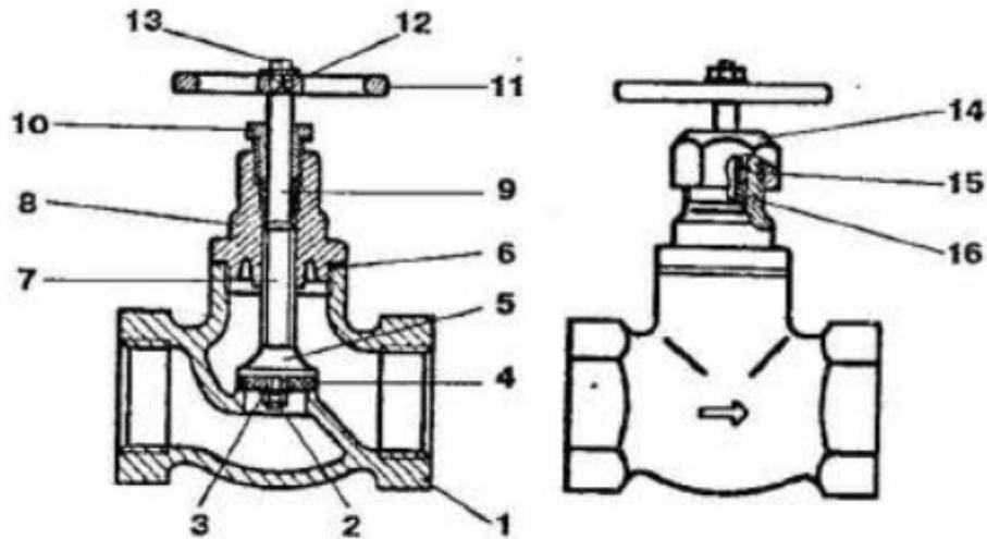
**Рис. 11. Устройство вентиля:** 1 — тело вентиля; 2 — гайка; 3 — шайба; 4 — прокладка; 5 — клапан; 6 — уплотнение; 7 — шток; 8 — спецтулка; 9, 16 — сальник; 10, 15 — втулка сальника; 11 — маховик; 12 — шайба; 13 — винт; 14 — накидная шайба
