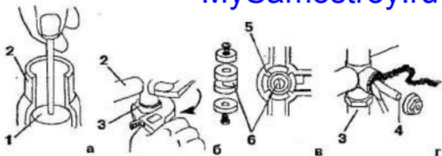
**Рис. 1В. Ремонт смесителя с золотникоым переключателем:**
