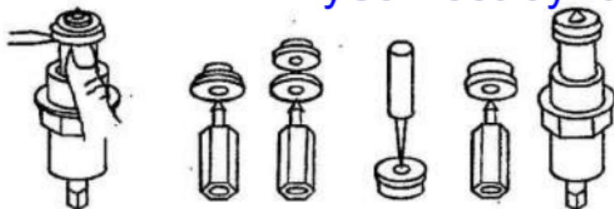
**Рис. 26. Последовательность замены изношенной прокладки в клапане**
