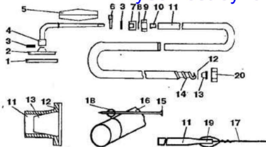
**Рис. 16. Гибкий резиновый шланг с душевой сеткой:** 1 — резиновое кольцо; 2 — душевая сетка; 3 — уплотнение; 4 — остав; 5 — рукоятка; 6 — петля; 7 — специальная гайка; 8 — резиновая прокладка; 9, 15 — накидная гайка; 10 — латунный ниппель; 11 — резиновая трубка; 12 — пластмассовая или латунная шайба; 13 — пластмассовый ниппель; 14 — хромированная латунная спиральная оболочка
