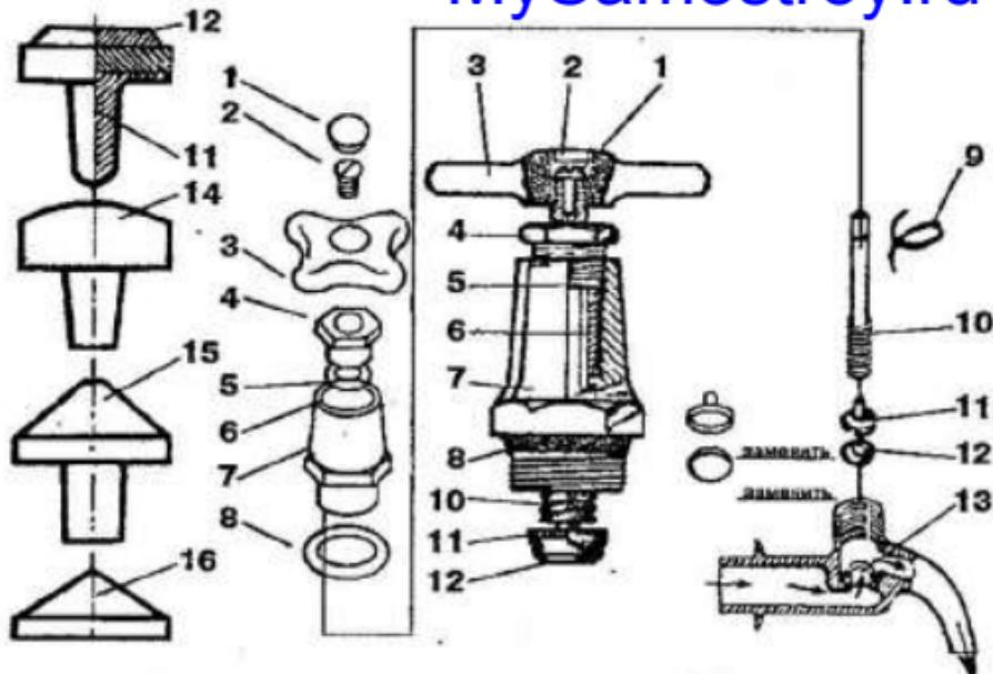
**Рис. 23. Вентильная головка с вращательно-поступательным движением штока:** 1 — указатель; 2 — винт; 3 — маховик; 4 — атулка сальника; 5 — латунное кольцо; 6 — набивка сальника; 7 — корпус; 8 — пластмассовая прокладка; 9 — уплотнительная набивка штока; 10 — шток; 11 — клапан; 12 — резиновая прокладка; 13 — седло корпуса крана (корпуса смесителя); 14 — пластмассовая прокладка-клапан; 15 — резиновая конусная прокладка-клапан; 16 — резиновая конусная прокладка
