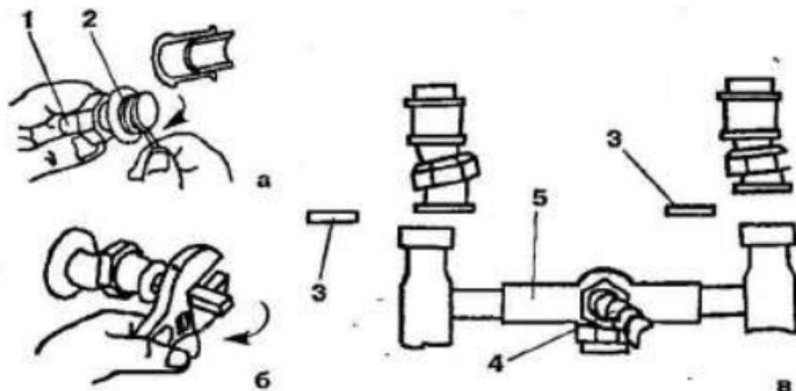
**Рис. 19. Смеситель с вертикально расположенным кнопочным переключателем и его монтаж на трубопроводах:** а — наматывание нитей уплотнения на патрубок; б — заворачивание патрубка; в — подсоединение корпуса к патрубкам, заворачиваемым постепенно в муфты трубопроводов; 1 — патрубок; 2 — декоративная шайба; 3 — уплотнительное резиновое кольцо; 4 — гибкий шланг; 5 — основание
