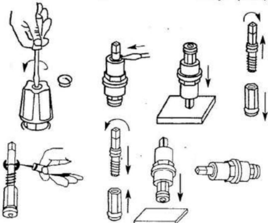
**Рис. 25. Последовательность замены резиновых колец в вентильной головке**
