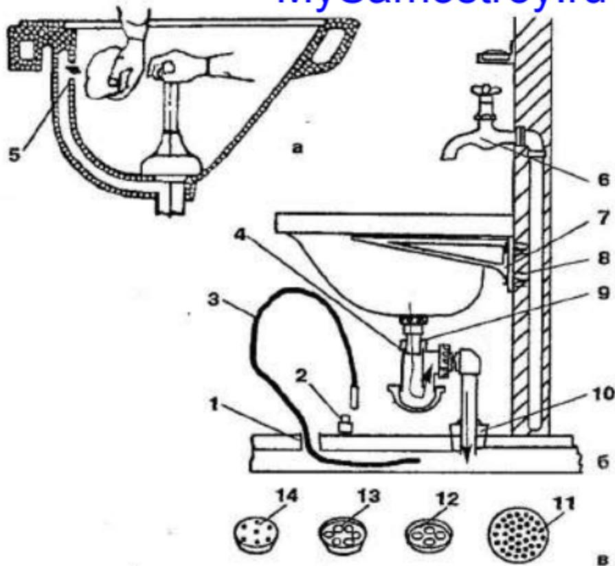
**Рис. 30. Установка и эксплуатация умывальника:** а — умывальник с переливом; б — умывальник без перелива; в — сетки для выпусколов; 1 — прочистка; 2 — заглушка; 3 — трос; 4 — пластмассовый бутилочный сифон для умывальников и моеек; 5 — перелив; 6 — кран; 7 — литой чугунный кронштейн; 8 — дюбель; 9 — пластмассовый выпуск; 10 — резиновое кольцо; 11 — металлическая сетка; 12, 13 — пластмассовые сетки; 14 — пластмассовая сетка на леске
