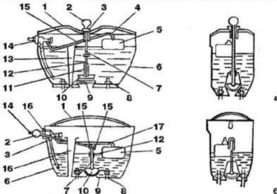
**Рис. 43. Устройство сливных бачков с боковым подводом воды:** а — с верхним пуском; б — боковым пуском; 1 — крышка бачка; 2 — кнопка пуска; 3 — гайка; 4 — рычаг клапана; 5 — поплавок; 6 — корпус; 7 — тяга; 8 — крепление к унитазу; 9 — седло; 10 — клапан; 11 — крепление клапана; 12 — направляющие; 13 — перелив; 14 — подвод воды; 15 — шайба; 16 — поплавковый клапан; 17 — рычаг поплавка.
