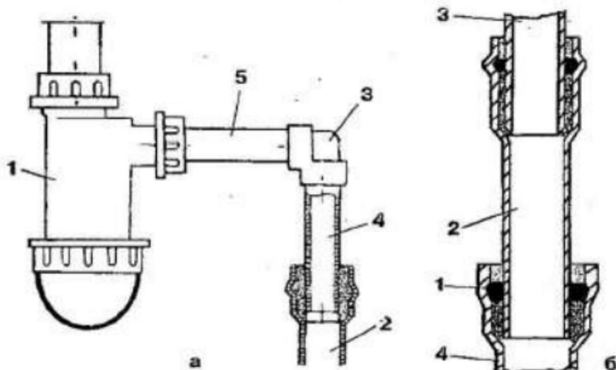
**Рис. 6. Варианты присоединения деталей из ПВХ к чугунным канализационным трубам:** а — бутылочного сифона (1 — сифон; 2 — канализационная труба; 3 — угольник; 4 — резиновая переходная деталь; 5 — отводная деталь); б — канализационной трубы (1 — просмоленная прядь и расширяющийся цемент; 2 — переходной патрубок; 3 — труба из ПВХ; 4 — чугунная труба)
