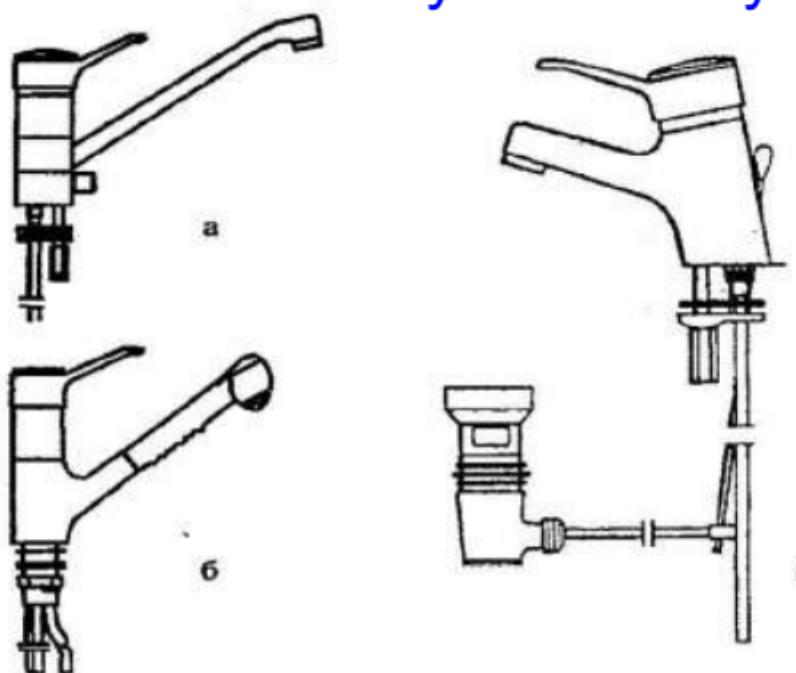
**Рис. 12. Некоторые модели шарнирных смесителей:** а — смеситель для кухонной мойки; б — смеситель для кухонной мойки с душевой сеткой на гибком шланге; в — смеситель для умывальника с управляемым выпуском
