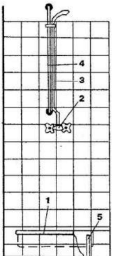
**Рис. 31. Душевая установка:** 1 — поддон; 2 — смеситель; 3 — душевая сетка на гибком шланге; 4 — держатель душа; 5 — выпуск
