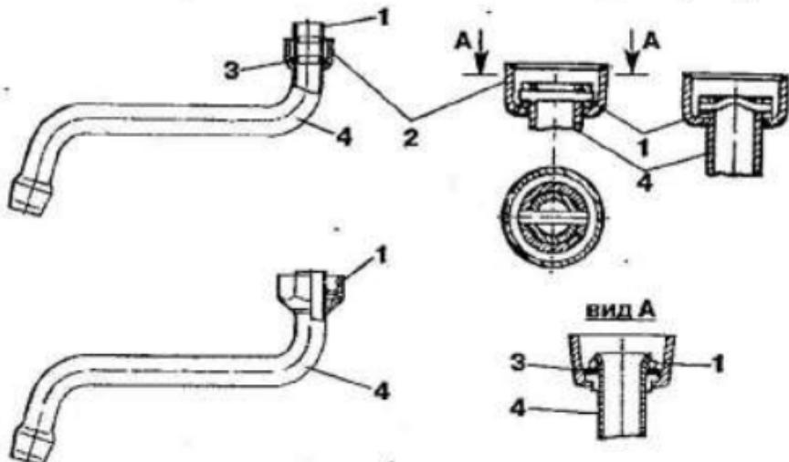
**Рис. 15. Излив смесителя пробкового типа:** 1 — резиновое кольцо; 2 — накидная гайка; 3 — разжимное пластмассовое кольцо; 4 — трубка
