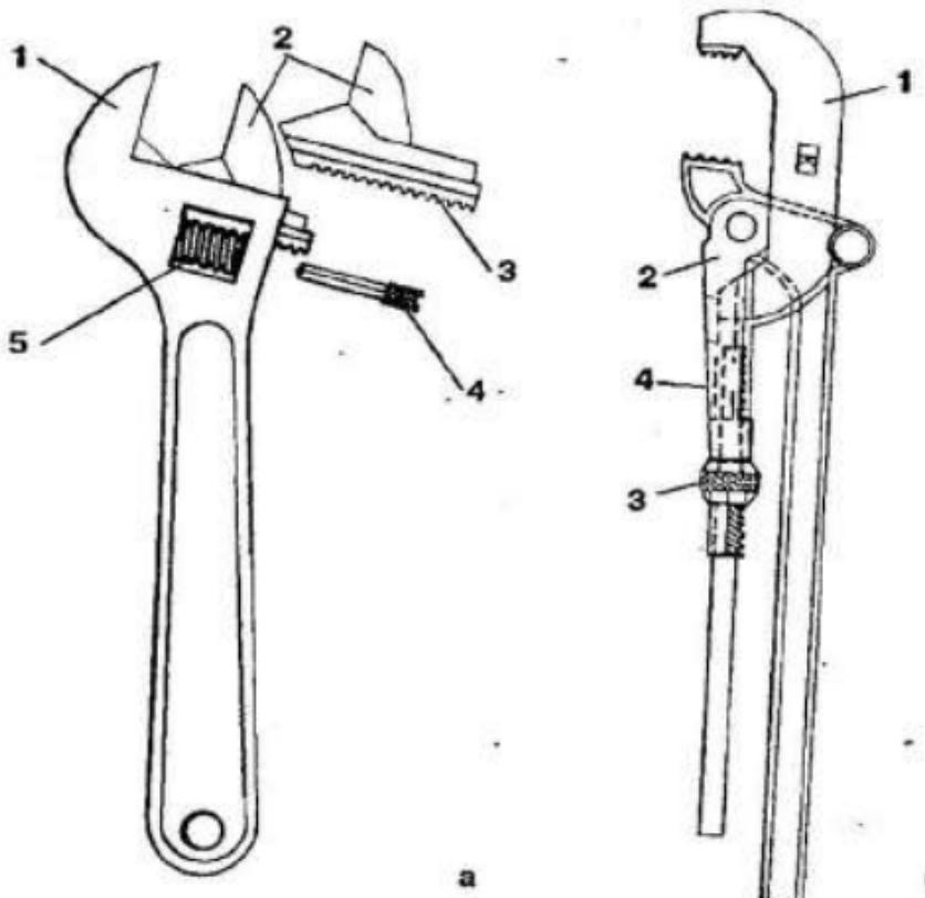
**Рис. 1. Ключи:** а — разводной гаечный (1 — неподвижная губка; 2 — подвижная губка; 3 — рейка; 4 — ось; 5 — червяк); б — трубный рычажный (1 — неподвижный рычаг; 2 — подвижный рычаг; 3 — гайка; 4 — обойма)
