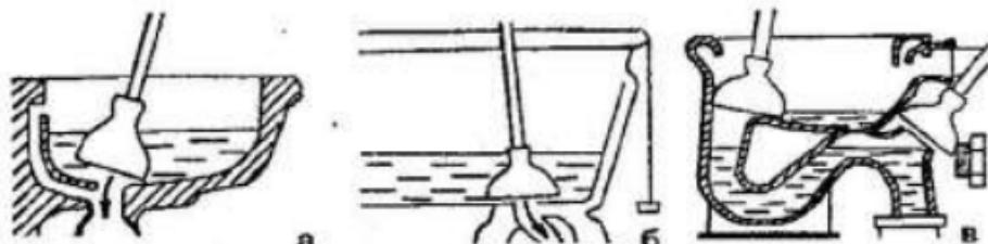
**Рис. 4В. Устранение засорений:** а — очистка канала раковины с помощью вантуза; б — очистка канала ванны с помощью вантуза; в — очистка канала унитаза вакуумированием
