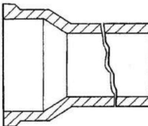
**Рис. 4. Чугунная канализационная труба с раструбом**
