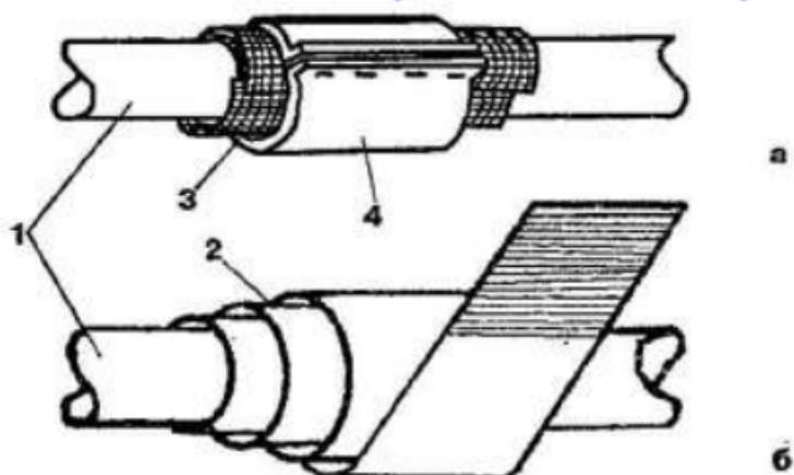
**Рис. 9. Ремонт трубопроводов:** а — бандаж с листовой резиной; б — клеевой бандаж (стеклоткань); 1 — труба; 2 — стеклоткань; 3 — резина листовая; 4 — металлический бандаж
