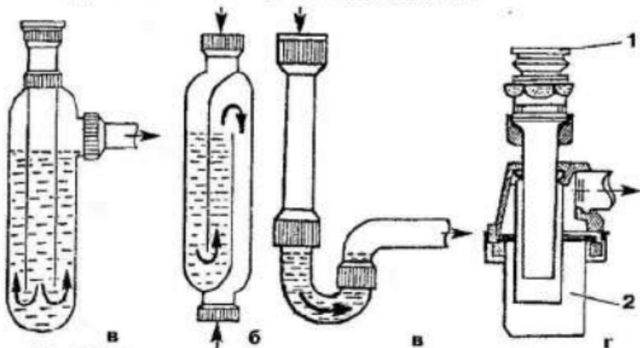
**Рис 39. Современные сифоны:** а — объемный с погруженной трубой; б — объемный с двумя перегородками; в — трубчатый; г — бутылочный латунный сифон: 1 — выпуск мойки (умывальника); 2 — «бутылка» сифона
