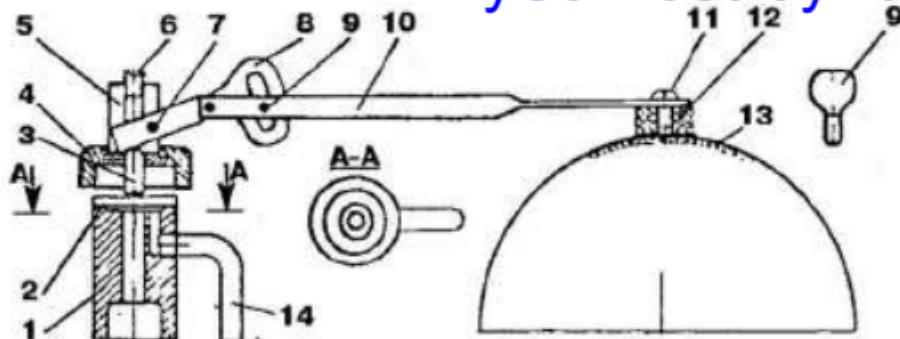
**Рис. 46. Вертикальный поплавковый клапан:** 1 — корпус клапана; 2 — резиновая прокладка; 3 — шток; 4 — накидная гайка; 5 — валик; 6 — специальный винт; 7 — шплинты; 8 — рычаг фасонный; 9 — барашек; 10 — рычаг поплавка; 11 — винт; 12 — втулка пластмассовая; 13 — поплавок; 14 — трубка сливная
