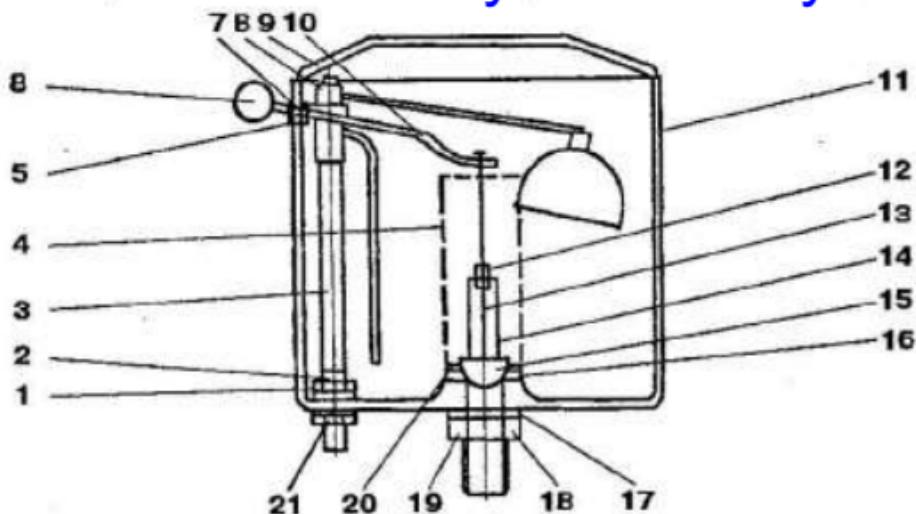
**Рис. 44. Смывной бачок с нижней подводкой воды:** 1 — резиновая прокладка и металлическая шайба; 2, 5, 21 — контргайки; 3 — стойка; 4 — перелив; 6 — ручка; 7 — втулка механизма спуска; 8 — вертикальный поплавковый клапан; 9 — крышка бачка; 10 — рычаг; 11 — корпус бачка; 12 — втулка; 13 — тяга; 14 — дуга; 15 — груша; 16 — резиновая прокладка седла; 17 — резиновая прокладка; 18 — металлическая шайба; 19 — гайка седла; 20 — седло
