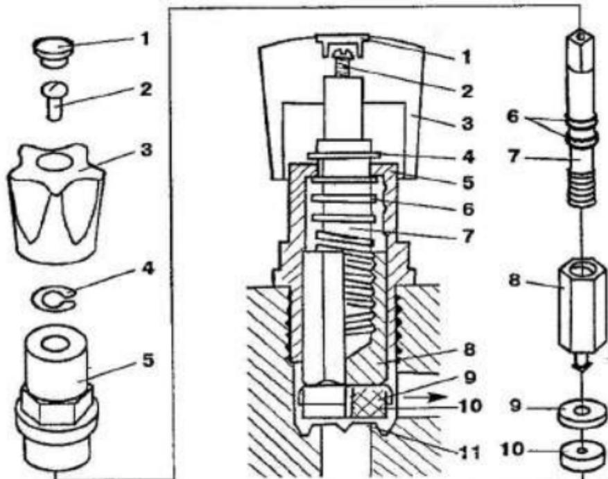
**Рис. 24. Вентильная головка с возвратно-поступательным движением шестигранного шпинделеля:** 1 — указатель; 2 — винт; 3 — маховик; 4 — стопорная шайба; 5 — корпус; 6 — резиновое кольцо; 7 — шток; 8 — шпиндель; 9 — клапан; 10 — прокладка; 11 — седло корпуса крана или смесителя
