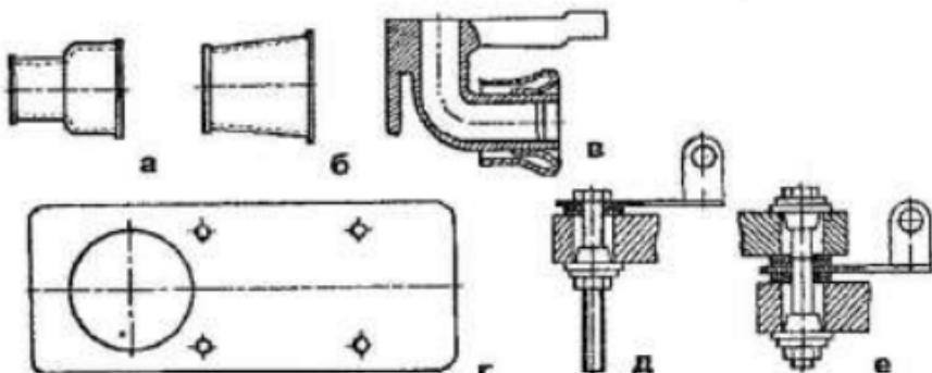
Рис. 42. Элементы унитазов: а, б — манжеты; в — выворачивание манжеты перед установкой на полочке; г — тафта; д — крепление кронштейна сиденья с цельнолитой полочекой; е — крепление кронштейна сиденья между унитазом и приставной полочекой
