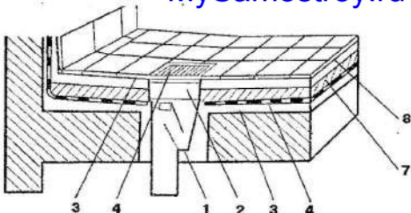
**Рис. 32. Сток воды с пола и водонепроницаемое уплотнение:**
