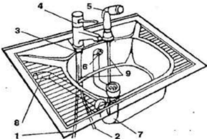
**Рис. 29. Система «смеситель—распылитель»:** 1 — подвод холодной воды; 2 — подвод горячей воды; 3 — подключение шланга для распылителя; 4 — смеситель с управляющим рычагом; 5 — распылитель; 6 — перелив мойки; 7 — сифон; 8 — труба слива грязной воды; 9 — шланг распылителя
