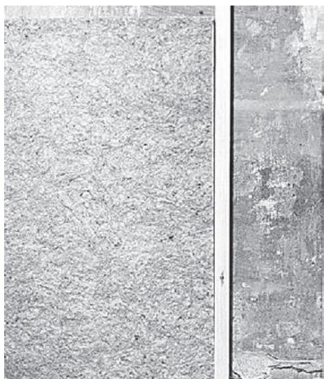
Рис. 4.25. Плита минеральной ваты
