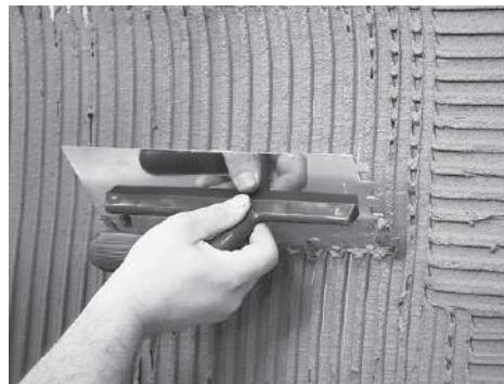
**Рис. 3.9.** Шпатель гипсокартонный с зубцами (американка)
