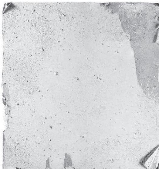
Рис. 10.8. Гипсокартон, поврежденный водой
