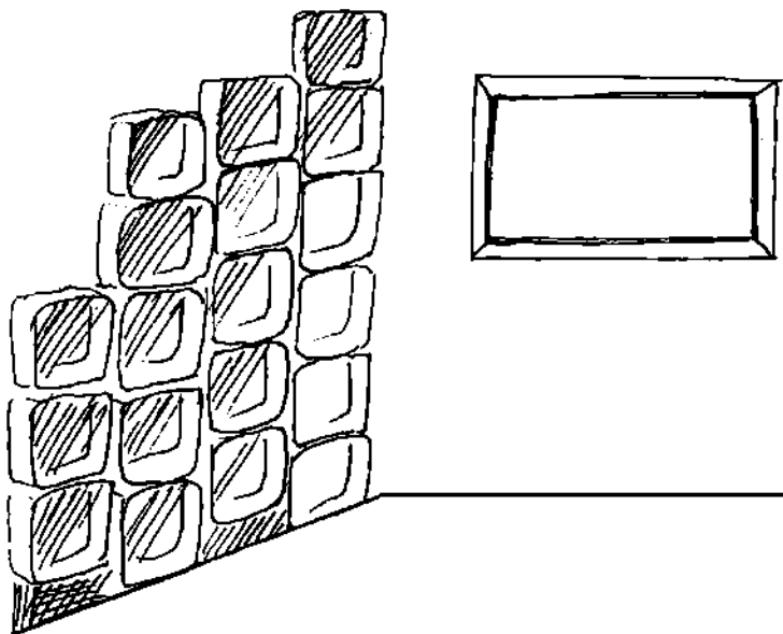
*Рис. 80. Перегородка из стеклоблоков*
