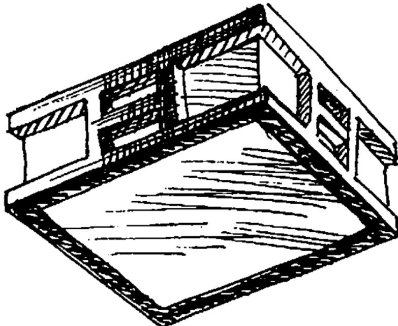
Рис. 21. Потолочный светильник
